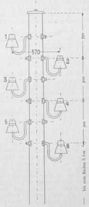
Fig. 6. Anordnung der Hochspannungs-Leitung. 1:20.
