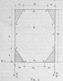
cadres intérieurs et aux cadres des appuis; dans le cas des premiers la force horizontale V est tout au plus égale à l'action du vent sur la moitié supérieure d'un panneau, dans le cas des cadres sur appuis la force V est à prendre égale à la réaction horizontale du contreventement supé-
