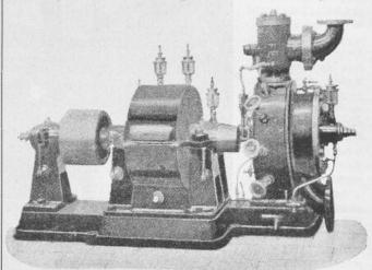
Fig. 7. Laval-Dampfturbine von 30 eff. P. S.
