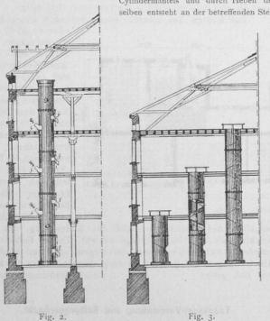
eine Oeffnung, durch welche von oben kommendes Fördergut austreten oder auch weiter nach unten zu transportierende Ware aufgegeben werden kann. Damit die auf der Schraubenfläche abgleitende Ware ohne Stoss nach der Oeffnung gerichtet und am weiteren Abwärtsgleiten verhindert werde, sind mit der Fallthüre F die Sperrwände G verbunden, welche
