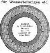
erscheint, im besonderen. wenn es sich darum handelt, gegen inneren und äusseren Druck widerstandsfähige Rohrleitungen durch Flüsse. Kanäle, Seen, Gebirge, Tunnels etc, zu verlegen.
