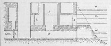
Fig. 4. Längsschnitt vom Einlauf des Emissars d. Fuciner-Sees. (Schematisch.) Legende: A, B, C. Flutschoss, D. Tunnel, E. Bassin.
