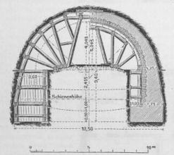
Fig. 7. Ausführung des zweigleisigen Tunnels in stark drückendem Gebirge.
