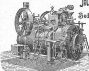
mit ausziehbar. Röhrenkesseln,
