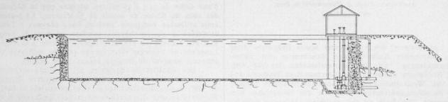
Fig. 23. Hochdruck-Reservoir. — Längenschnitt 1:300.
