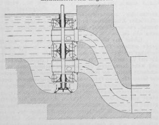
Fig. 21. Gesamtanordnung der Turbinen, Gebaut von Bell & Cie, in Kriens (Patent Schaad).
