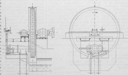
Fig. 25. Projekt einer Hochdruckturbine von 2200 P. S. für das Elektricitätswerk in Rageat.1) 1:80. Gebaut von Piccard & Pictet in Genf.
