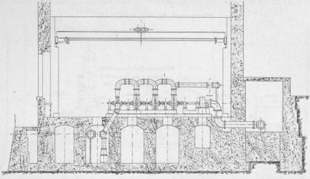
Fig. 19. Pumpenanlage im Wasserwerk Combe-Garot. Gebaut von Piccard & Pictet in Genf.
