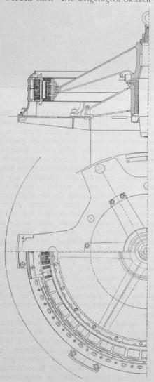
Fig. 7. Zweiphasen-Wechselstrom-Generator von 1200 P. S. Neuere Aussuhrung der Cie. de l'Industrie électrique. 1:50.
