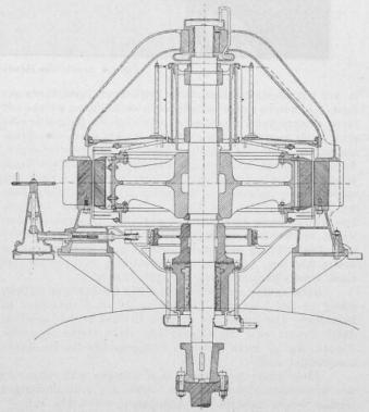
Fig. 8. Gleichstrom-Generator von 1200 P. S. Gebaut von der Cie. de l'Industrie électrique. 1:50.
