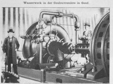
Fig. 1. Hochdruckcentrifugalpumpe. (Gebaut von Gebr. Sulzer).
