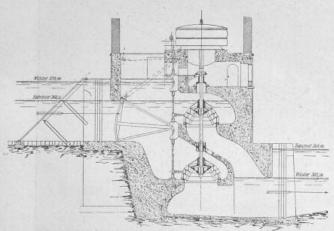
Fig. 5. Turbinenanlage älterer Ausführung.
