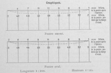
Les poutrelles en fer double T de 250/115/11 et du poids de 43 kg par m courant, sont supportées par des étriers fixés aux montants en chêne.
