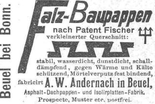
stabil, wassererdicht, dicht, schall-dämmend, gegen Wärme und Kälte schützend, Möbelverputz fest bindend, fabrik A.W. Andernach in Beuel,
