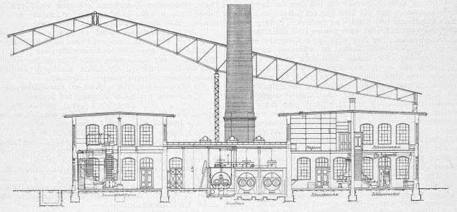
Fig. 33. Querschnitt durch die Ammoniakfabrik, das Dampfkesselhaus und Werkstättengebäude.
