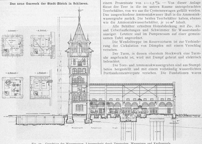
Fig. 32. Grundrisse des Wasserturmes, Längenschnitt durch Teergruben, Wasserturm und Kraftcentrale.
