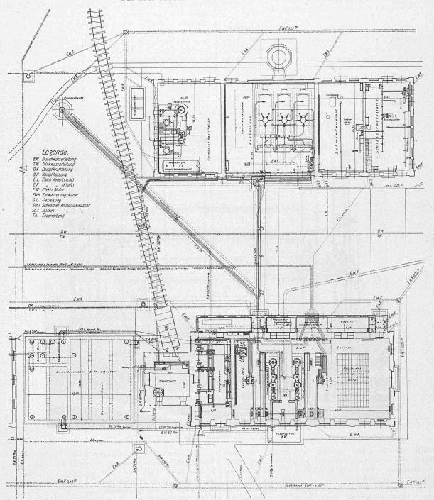
Fig. 30. Grundriss vom Dampfkesselhaus, der Kraftcentrale, Pumpenanlage, den Teer- und Ammoniakwassergruben.
