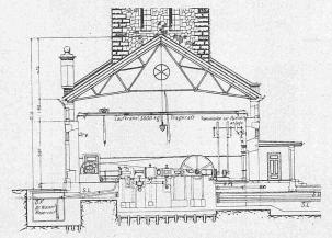
Fig. 36. Querschnitt durch die Kraftcentrale. 1:300.
