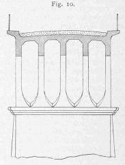
im Kämpfer die erforderliche Materialmenge finde, werden dort die senkrechten Rippen verbreitert, während die Fahrbahndecke umgekehrt gegen die Auflager zu geschwächt wird. Rundeisen laufen sowohl der obern geradlinigen Kante wie der Bogenlinie entlang.
