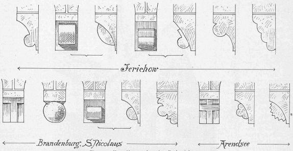
Fig. 15. Konsolformen deutscher Backsteinbauten.
