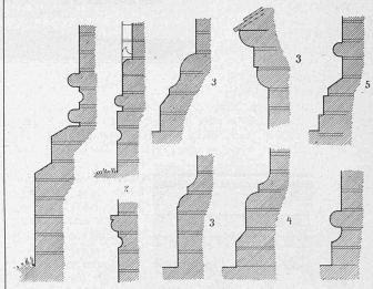
Fig. 17. Gesimsprofile deutscher Bauten.
