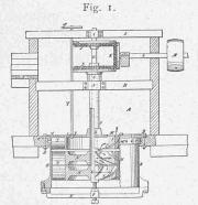
Wie aus nebenstehender Skizze Fig. 1 der Faulkner'schen Konstruktion zu ersehen ist, findet hier keine Teilung der Wassermenge und kein Energietransport in obigem Sinne statt, sondern es wird bei Hintereinanderschaltung der beiden, von derselben
