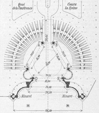
Fig. 1. Grundriss der Haupteingangs-Halle. 1:720.
