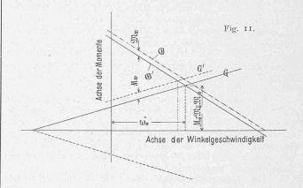
Für die graphische Darstellung ist es übersichtlicher, den Wert von M ohne Rücksicht auf das — Zeichen in das Koordinaten-System einzutragen (entsprechend einem Zusammenklappen der positiven und negativen Ordinatenebenen) und erhält man hiedurch als Darstellung von M
