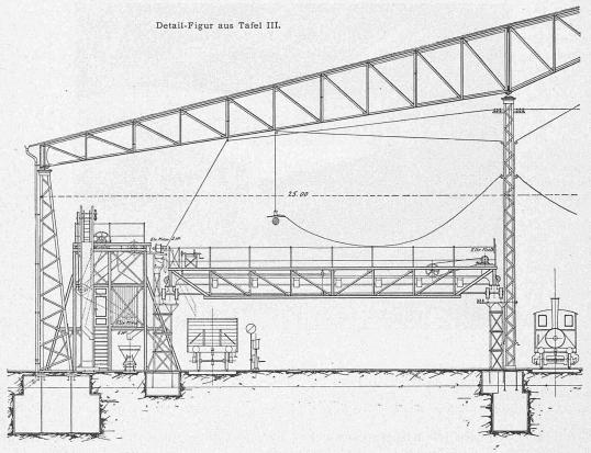
Fig. 9. Kokeaufbereitungsanlage mit Längs- und Quertransport. Querschnitt A-B. 1:200.
