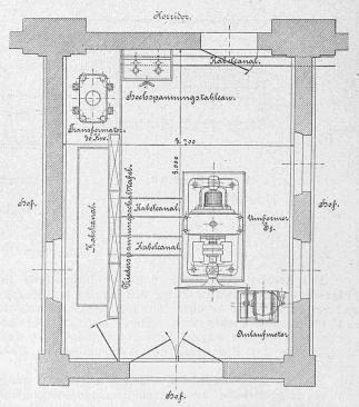
Fig. 2. Situationsplan des Maschinenlokals. 1:60.
