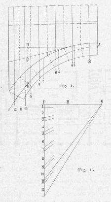
fuge (A und B in Fig 1), den ersten im äusseren, den zweiten im inneren Drittel der betreffenden Fuge, und konstruiert eine Drucklinie durch die zwei Punkte, indem man den Pol des Kräftepolygons (Fig. 1') so bestimmt, dass der Strahl durch den Scheitel horizontal geht.
