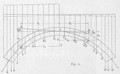
die drei Punkte A, B, C, und die Drucklinie ist so gezeichnet. dass die den Kräftepolygonstrahlen 1-1', 8-9 und 6'-7 entsprechenden Seiten der Drucklinie durch A, B, C gehen. Die Lage des Poles O ist durch die Horizontal- und Vertikal-
