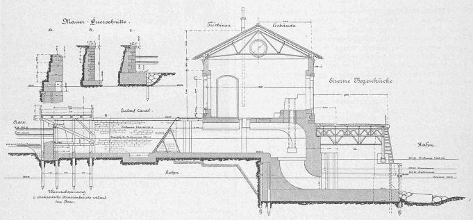
Fig. 11. Querschnitt der Turbinenanlage 1:250.
