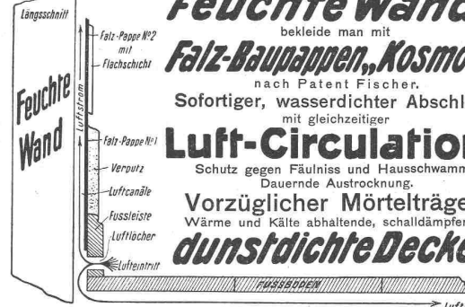
N o 1 mit Verputz Luft-Canäle N o 2 mit Flächschicht, deshalb ohne Verputz
