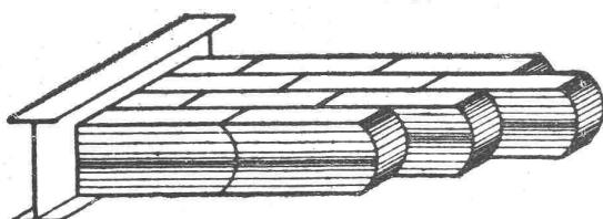
Dieses neue, geradlinige, massive Deckensystem zeichnet sich durch grösste Einfachheit aus. Es ist nur ein Formstein notwendig, kann von jedem tüchtigen Maurer ohne Schalung mit Kalkmörtel ausgeführt werden. Beliebige Trägerdistanzen von 0,5—2,5 m. Grosse Nutzlast und Eisenersparnis.
