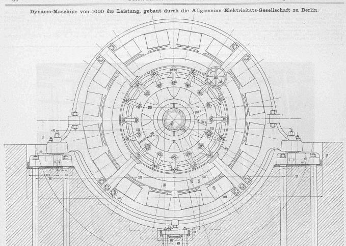
Fig 3. Vorderansicht. — Masstab 1:40.
