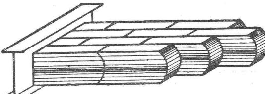
Dieses neue, geradlinige, massive Deckensystem zeichnet sich durch grösste Einfachheit aus. Es ist nur ein Formstein notwendig, kann von jedem tüchtigen Maurer ohne Schalung mit Kalkmörtel ausgeführt werden. Beliebige Trägerdistanzen von 0,5—2,5 m. Grosse Nutzlast und Eisenersparnis.
