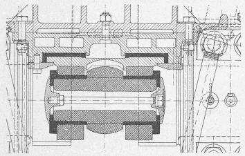
Fig. 12. Kreuzkopf. — Detail aus Fig. 11. — 1:15.
