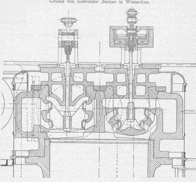
Kopf des Hochdruckcylinders. - Detail aus Fig. 2 (Siehe Doppeltafel). 1:15.
