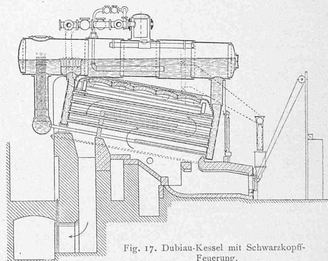
Fig. 17. Dubiau-Kessel mit Schwarzkopff Feuerung.
