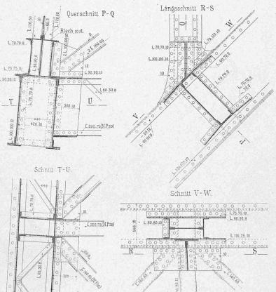
Fig. 16-19. Pfeiler- und Querverbindungsanschluss am Bogen 1:30.
