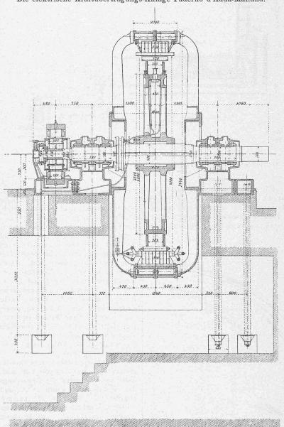
Fig. 15. Längsschnitt durch Generator und Erregerdynamo. 1:50.
