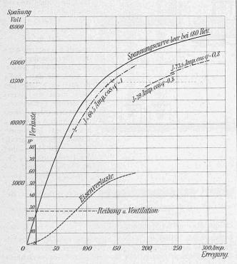
Fig. 14. Spannungskurve eines Generators von 2160 P. S. bei 180 Umdr. 42 Perioden pro Sek., 13500—15000 Volt.
