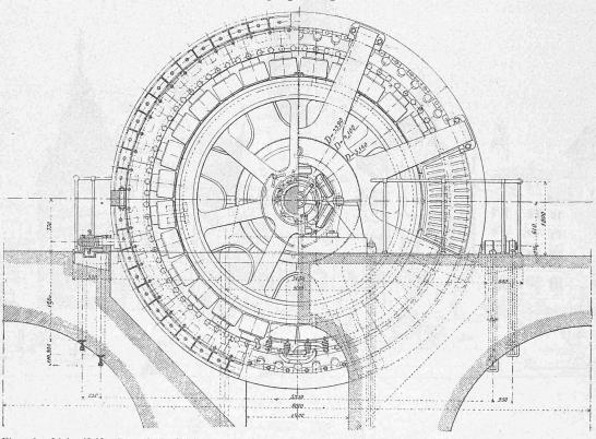
Fig. 16. Linke Hälfte Querschnitt durch den Dreiphasen-Generator, rechte Hälfte Ansicht vor der Erregerdynamo. 1:50. Leistung 2160 P. S. (1590 kw), Umdr. pro Minute 180, Periodenzahl pro Sek. 42, Spannung 13500 Volt.
