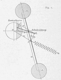
sehen ist, da bekanntlich neuerdings eine Drosselung des Dampfes bei kleinen Füllungen sowohl im Interesse der Dampfökonomie wie der Regulierung häufig mit Absicht herbeigeführt wird. Die Verstellkraft wird bei dieser Reglerart im Wesentlichen durch die Beharrungskräfte geliefert, und kann die in der Feder aufgehäufte Energie dementsprechend klein angenommen werden. Die interessanteste Eigenschaft des Beharrungsregulators besteht darin,
