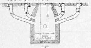
ternungen von 150-200 m durch Vertiefung der Spurkranzrille Schlitze von 100 mm Länge angeordnet werden, durch welche das in der Rille laufende Wasser in einen Gusskörper abfliesst. Aus diesem gelangt es in einen Sammler behufs Ablagerung des mitgeführten Sandes und wird dann dem Strassenkanal zugeführt (s. Fig. 4).
