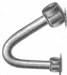
**Pleuelstange, 45 mm dick, hohl gegossen,** blank gedreht, nachher unter dem Hammer kalt zusammengeschlagen, ohne irgend welche Risse oder Bruchstellen, auch mit der Loupe betrachtet, zu zeigen.
