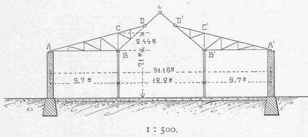
In der Längsrichtung sind die Binder durch die bereits erwähnten Längsträger, ferner durch Pfetten und durch in der Dachfläche liegende Diagonalverstrebungen (Fig. 2) verbunden. Die ganze Dachkonstruktion zerfällt der Länge nach in mehrere Teile, von denen jeder sich unabhängig ausdehnen kann. Zu diesem Zwecke sind die Längsverbindungen an entsprechenden Stellen mit beweglichen Stößen versehen.
