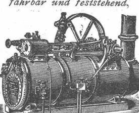
ferner transportable Dampfmaschinen mit stehendem geschweisstem Querrohrkessel bauen als Spezialität und halten auf Lager
