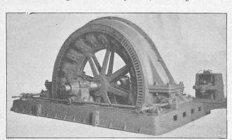
Fig. 6. Wechselstrom-Generator.
