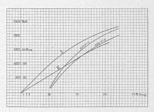
Fig. 7. Leerlauf- und Kurzschluss-Charakteristik der Maschinen.
