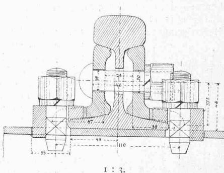
Fig. 14. Oberbau. — Schienenstoss. Ansicht.
