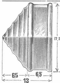
Falconnier's Patent-Glas-Bausteine aus geblasenem Glase. Vorzügliches zweckmässiges Baumaterial für Gewächshäuser, Veranden, Lichtöffnungen, Operationssäle, Zwischenwände. Zufolge ihrer starken Isolierfähigkeit speziell geeignet für Fenster und Zwischenwände in Lager- und Gärkellern, Abfüllkellern, Speisekellern für Flaschen- und Obstkeller, sowie für möglichst schalldichte (Telephon) Gesprächskästen.
