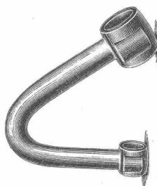
Pleuelstange, 45 mm dick, hohl gegossen, blank gedreht, nachher unter dem Hammer kalt zusammenschlagen, ohne irgend welche Risse oder Bruchstellen, auch mit der Loupe betrachtet, zu zeigen.
