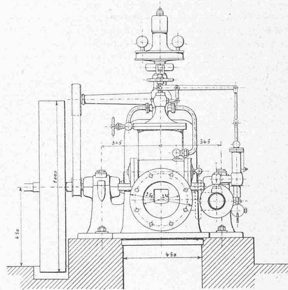
obenstehende Stange des im Cylinder dicht geführten Kolbens nach aussen geführt ist; am oberen Ende derselben befindet sich das Scharnier, durch welches die Kolbenstange mit dem Hebel behufs Rückführung des Ventiles verbunden ist; unterhalb dieses Scharnieres ist ein anderes Hebelwerk mit der Kolbenstange verbunden, dessen Zweck später erläutert wird.
