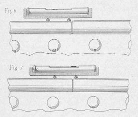
In dieser Lage beobachtet man die Stellung der Blase und verschiebt nachher die Libelle so weit, dass das eine Schräubchen auf die folgende Schiene zu stehen kommt (Fig. 7). Aus dem Ausschlag der Blase lässt sich dann die Höhendifferenz der Schienenenden mit aller wünschbaren Genauigkeit bestimmen.
