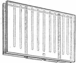
Durch Einziehen pat. eiserner Rohrverspannungen wird die Herstellung beliebig langer oder hoher Wände ohne Riegelung ermöglicht.
