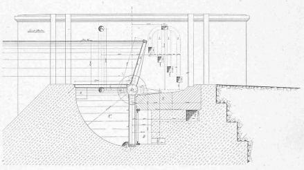
Schnitt durch das Trommelwehr. Masstab 1:125.
