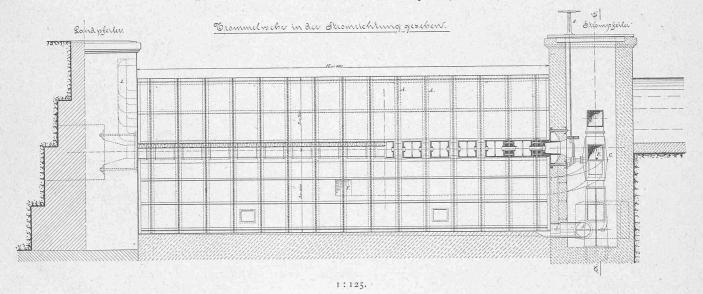
Vierweghahn so gestellt, dass das Oberwasser in die Hinterkammer tritt. Durch den auf die Gegenklappe ausgeübten Druck, dreht sich dieselbe in der Trommel nach aufwärts, während sich die Wehrklappe in gleicher Weise senkt und das in der Vorderkammer befindliche Wasser nach dem Unterwasser abfliesst. Beim Aufrichten des Wehres wird die Vorderkammer mit dem Oberwasser in Verbindung gesetzt, die Gegenklappe durch das eindringende Wasser
