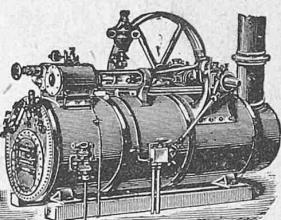
ferner transportable Dampfmaschinen mit stehendem geschweißtem Querrohrkessel
