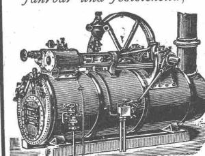
ferner transportable Dampfmaschinen mit stehendem geschweißten Querrohrkessel
