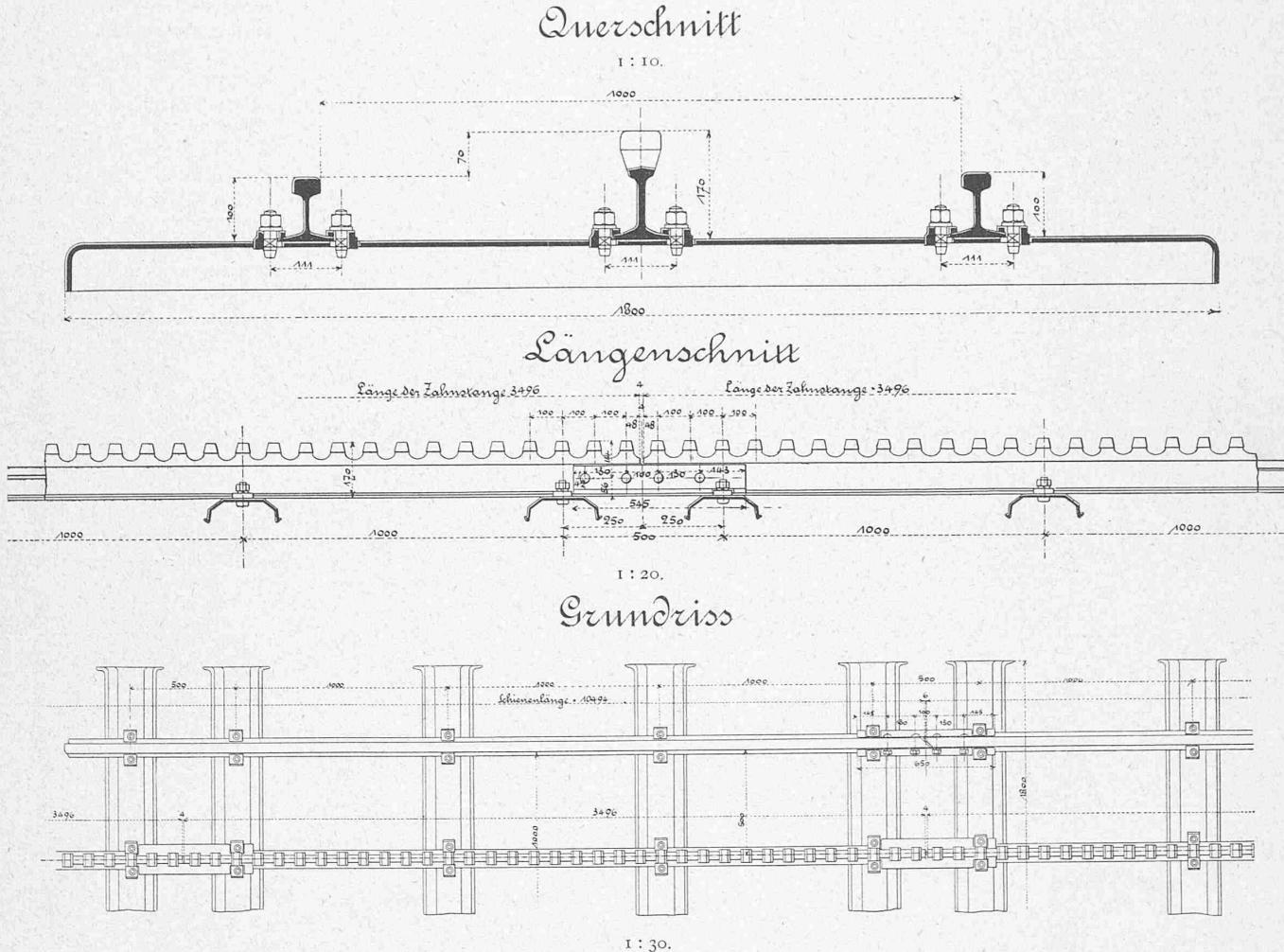
im Betriebe anderer Zahnradbahnen verlangen vom heutigen Oberbau und Rollmaterial erhöhte Betriebssicherheit. Für die lange und steile Bahn war ein nicht sehr schweres, aber gleichwohl recht widerstandsfähiges Geleise erwünscht. Ausserdem beeinflussten die Wahl der Oberbauprofile folgende, die Zusammenghörigkeit zwischen Fahrzeug und Oberbau betreffende Erwägungen:
