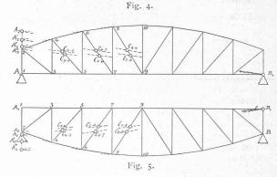
In Fig. 5 ist die Fahrbahn oben, die Streben steigen gegen die Mitte. Auch hier ist  $B_1$  allen Linien  $A_2$   $B_1$  gemeinschaftlich. Auf jeder Strebe sind zwei Grenzpunkte, der *untere* für die *Strebe*, der *obere* für den links benachbarten Pfosten.
