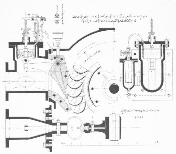
U. Bosshard, Ingenieur in Zürich, hat eine Serie von Hochdruckturbinen mit löffelförmigen Schaufeln ausgestellt, von denen eine mit Handregulierung und die übrigen vier mit automatischer Regulierung nach obenskizzierter Konstruktion ausgeführt waren.
