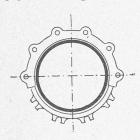
erhalten, wurde von gewöhnlichen Muffenröhren mit Bleidichtung abgesehen und dieselbe nach nebenstehender Skizze aus Röhren mit Stopfbüchsendichtung und Kautschuk - Verpackung ausgeführt. Die Lieferung der Röhren geschah durch die L. von Rollschen Eisenwerke, welche diese Rohrverbindung für Pressluftleitungen, sowie für Gas- und Wasserleitungen auf beweglicher Unterlage (Brücken etc.) ausführen.
