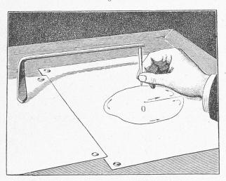
und markiert man die Berührungspunkte der Schneide mit dem Papier vor und nach der Umfahrung, so gibt die Distanz dieser beiden Punkte mit der Länge des Stabes multipliciert den Flächen-Inhalt der Figur. Man hat dabei nur darauf zu achten, dass die grösste Dimension der Figur die halbe Länge des Stabes nicht übertreffe, dass also zu grosse Figuren in Partien zerlegt werden und dass die Umfahrung in einer bestimmten Weise vor sich gehe, die wir noch näher beschreiben werden.
